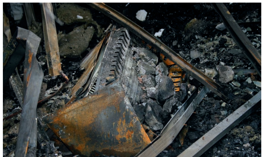
Bild 7 | Die Überreste des stark zerstörten Saunaofens
