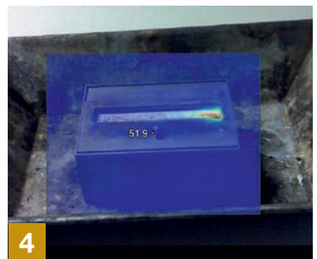
Bild 2 | Im Brandversuchshaus des IFS wurde der Ethanolkamin wieder in Betrieb genommen. Nach dreieinhalb Stunden waren die Flammen scheinbar erloschen. Erst bei genauer Nachschau waren noch kleine Flammen zu erkennen, die unter den keramischen Holzimitaten verborgen sind.
